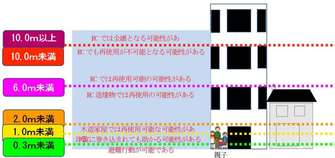
図 津波の浸水深と津波被害の関係
