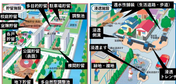
図 雨水貯留浸透施設
