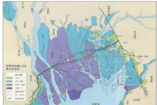
図 伊勢湾台風による堤防決壊箇所と浸水状況図
