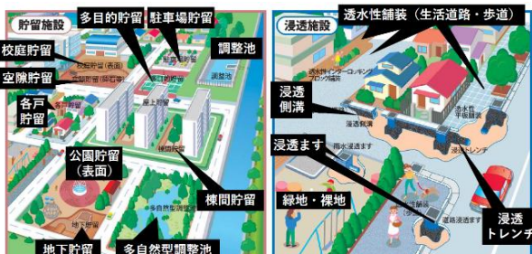
図 雨水貯留浸透施設
