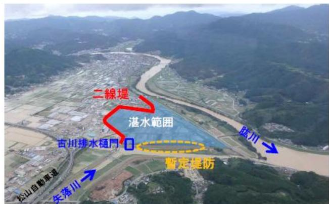
写真 二線堤の整備事例
