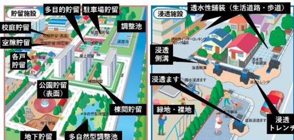
図 雨水貯留浸透施設
