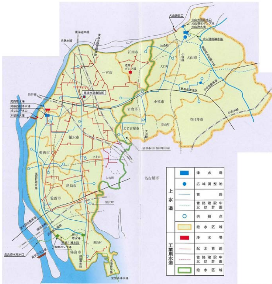
図 1.47 愛知県企業庁尾張水道事務所系統概要図
