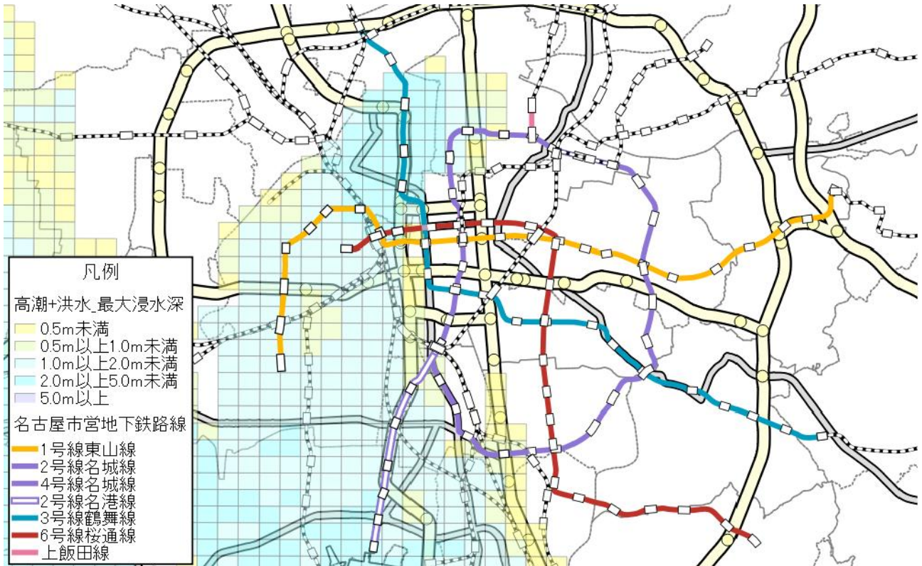
図 1.55 浸水想定範囲図と地下鉄路線図
