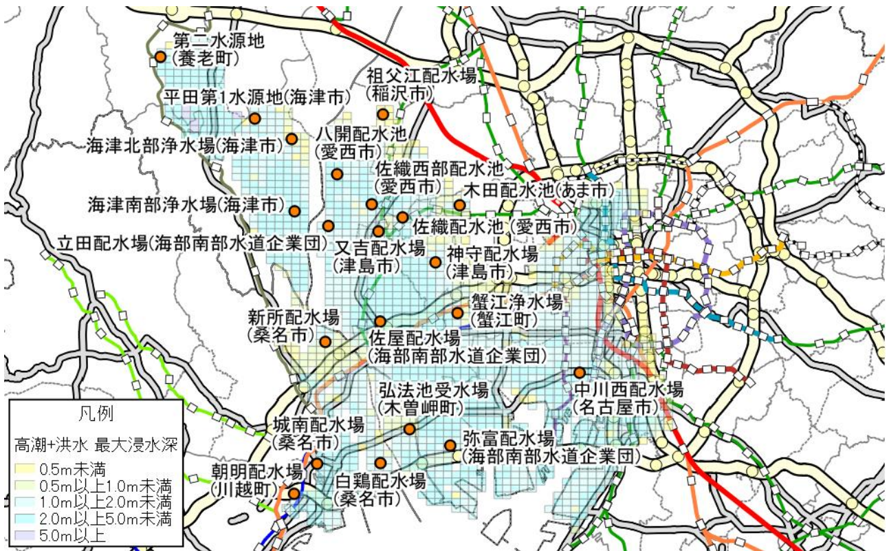
図 1.48 浸水想定範囲と上水道施設箇所図
