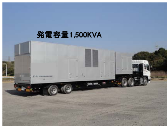
災害時の製品出荷対策(移動式非常発電設備)
