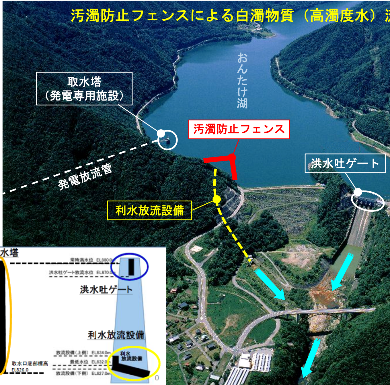
取水口前面にフェンスを設置し、火山噴出物の流出抑制を図る。
