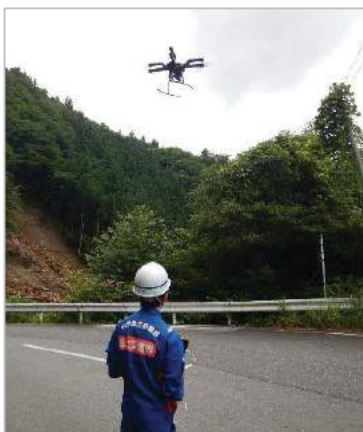
全天候型ドローン による調査
