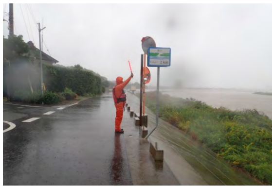
見通し杭(国安水位観測所)
