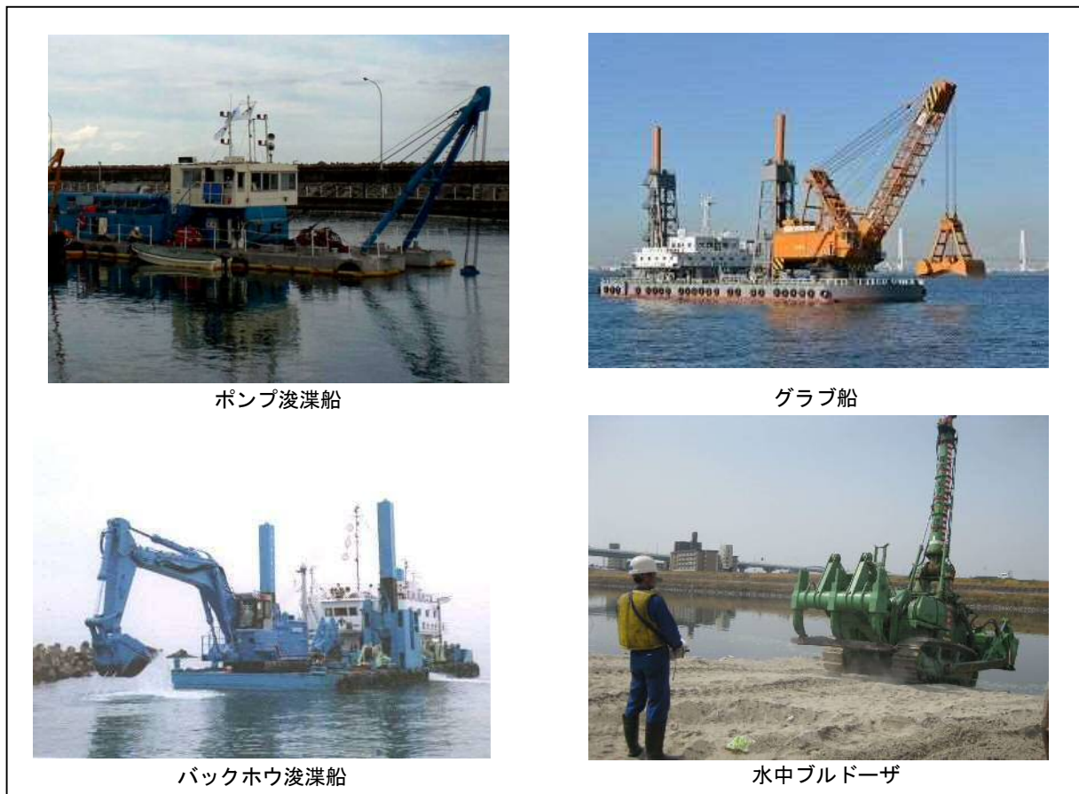
図 5-1-7 水中での施工における施工機械の例
