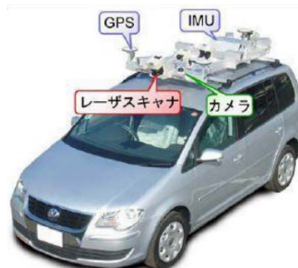
(d) Mobile Mapping System (MMS) 自動車から堤防表面に向けてレーザを照射することで地形を計測する技術
