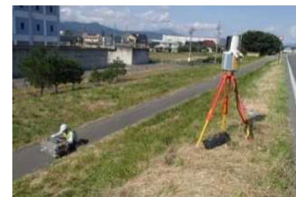
(e) 地上設置型レーザ測量技術 三脚に設置されたレーザ照射装置からレーザを照射することで地形を計測する技術
