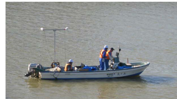
(b) 音響測深 水上を移動する船舶から河床に向けて超音波を発信することで河床高を計測する音響測深技術
