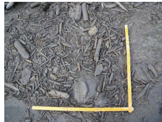
吸引部に入り込んだゴミの様子
