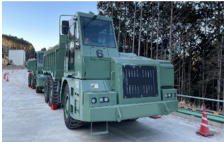
①GTL fuelを採用したオフロードダンプ（掘削ずり運搬）
