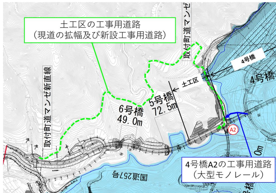
工事用道路＋大型モノレール
