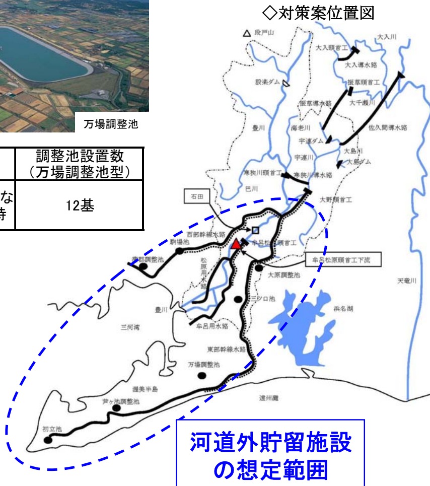
図 4.4.2 河道外貯留施設対策案の概要
