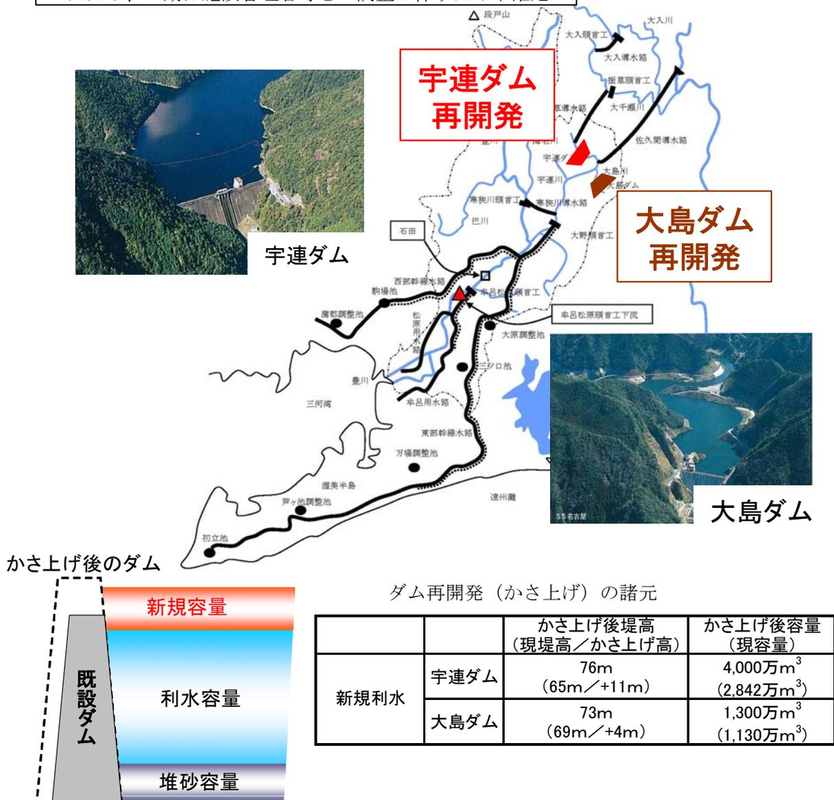
図 4.3.15 ダム再開発対策案の概要
