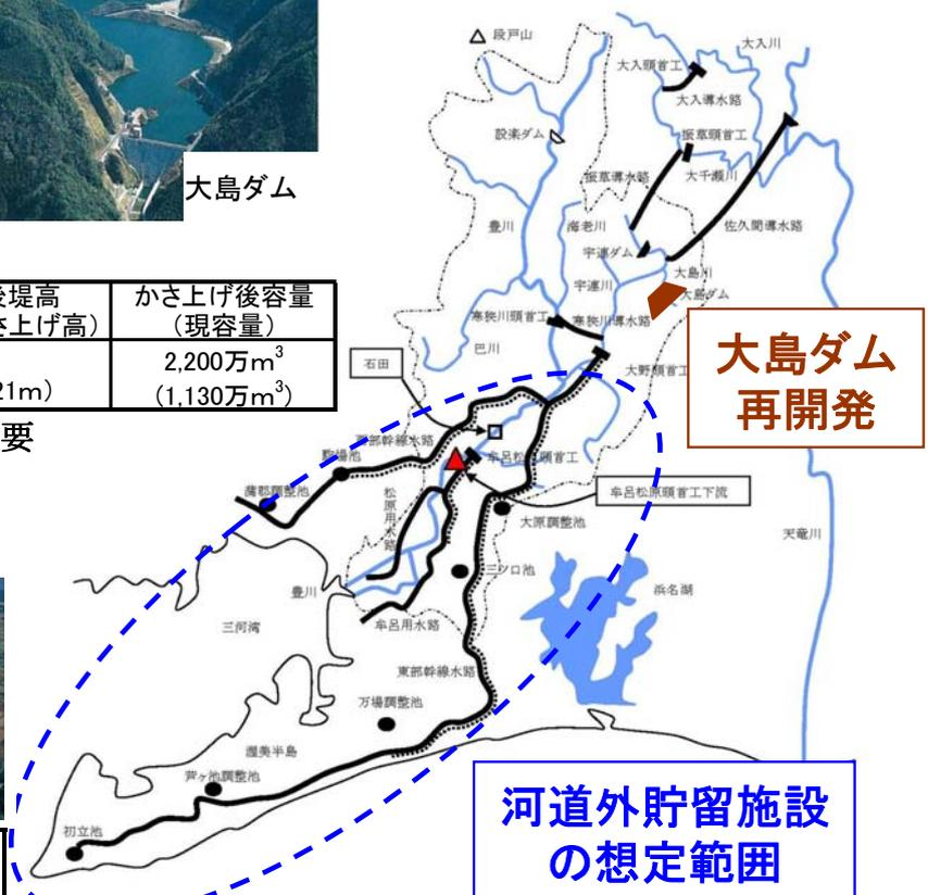
図 4.3.23 河道外貯留施設+ダム再開発 (大島ダム) 対策案の概要
