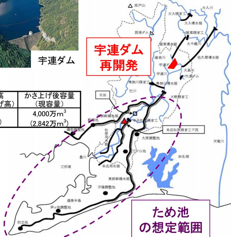
図 4.3.24 ダム再開発（宇連ダム）＋ため池対策案の概要
