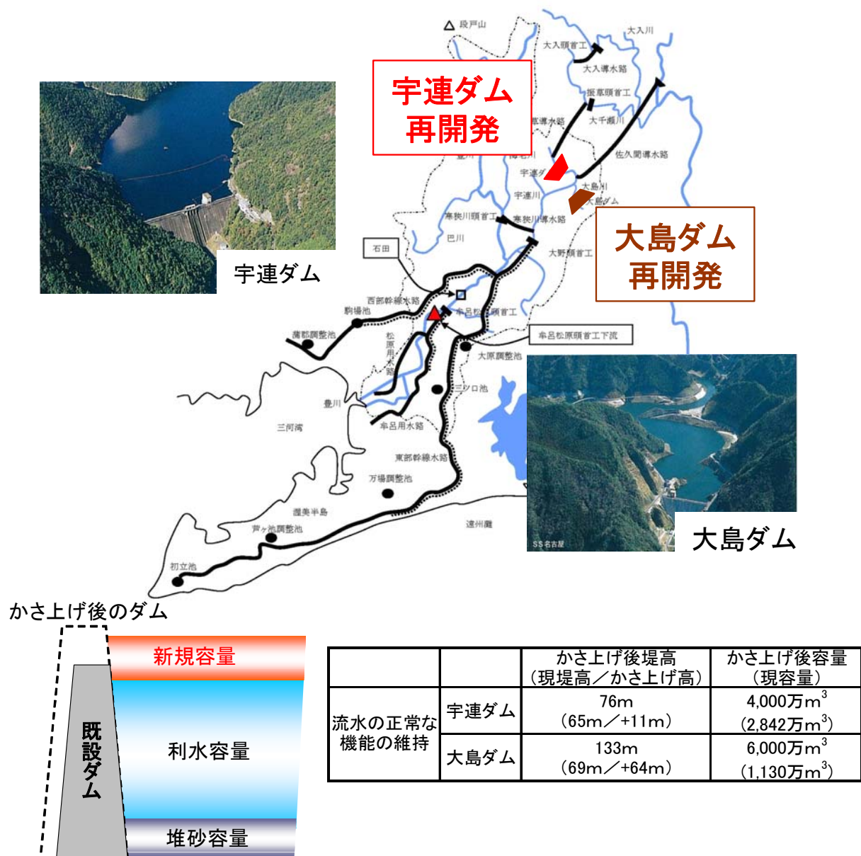
図 4.4.3 ダム再開発対策案の概要
