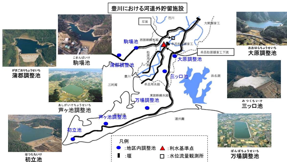
図 4.3.2 豊川における河道外貯留施設
