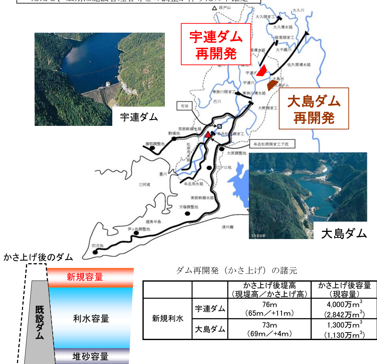
図 4.3.15 ダム再開発対策案の概要
