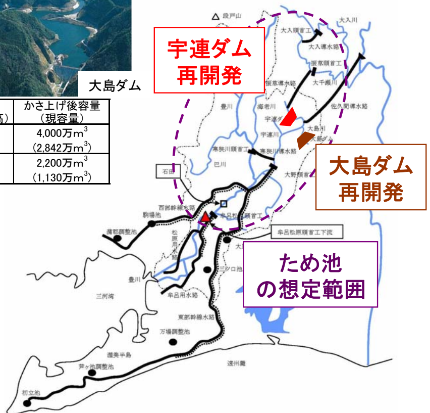
図 4.4.13 ダム再開発（宇連ダム、大島ダム）＋ため池対策案の概要
