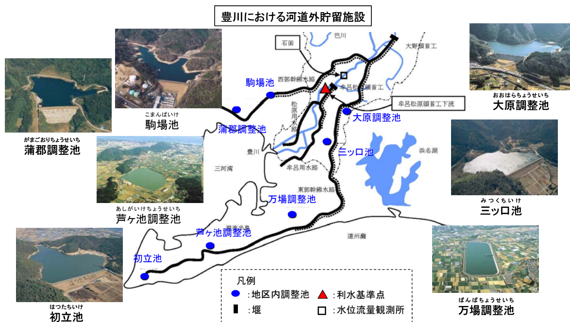
図 4.3.2 豊川における河道外貯留施設
