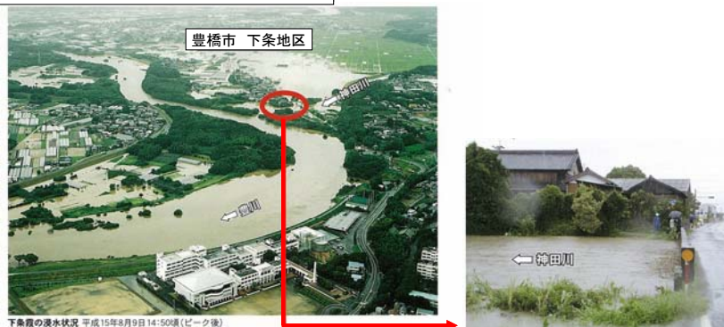
図 4.2.20 霞堤の存置のイメージ
