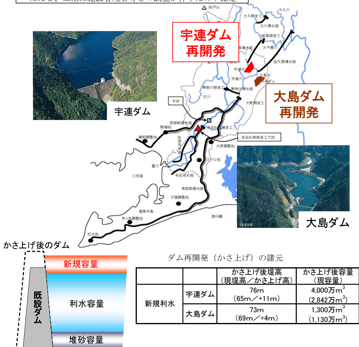
図 4.3.15 ダム再開発対策案の概要
