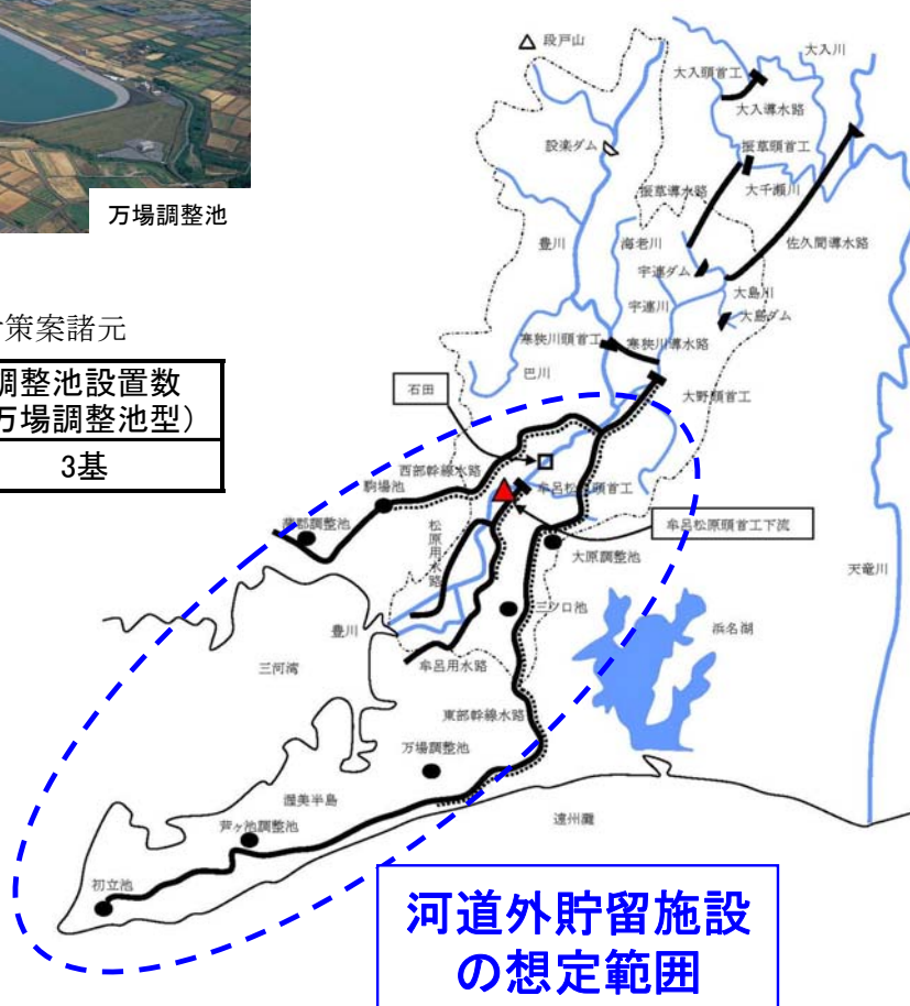
図 4.3.14 河道外貯留施設対策案の概要
