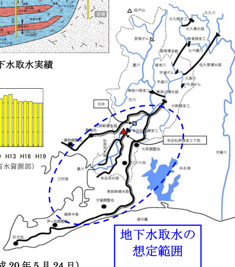
図 4.3.18 地下水取水対策案の概要
