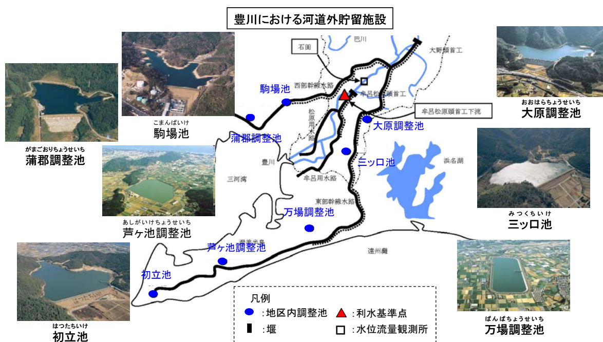
図 4.3.2 豊川における河道外貯留施設
