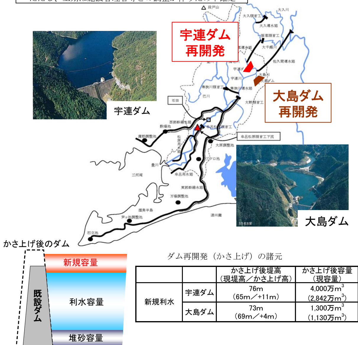
図 4.3.15 ダム再開発対策案の概要
