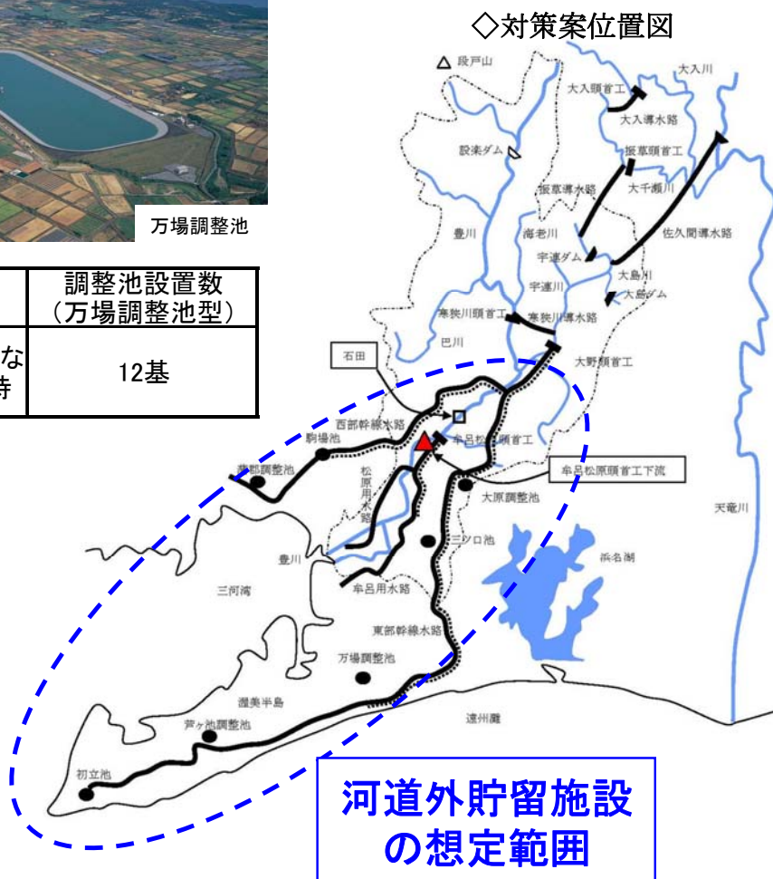
図 4.4.2 河道外貯留施設対策案の概要
