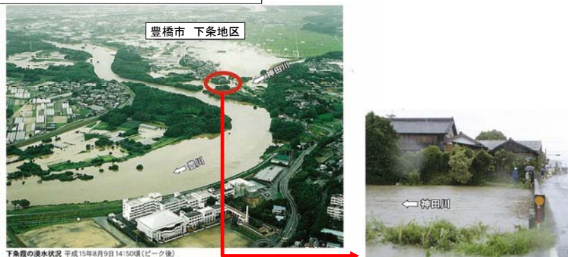
図 4.2.20 霞堤の存置のイメージ
