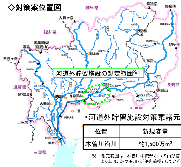
図 4.4.3 河道外貯留施設の概要
