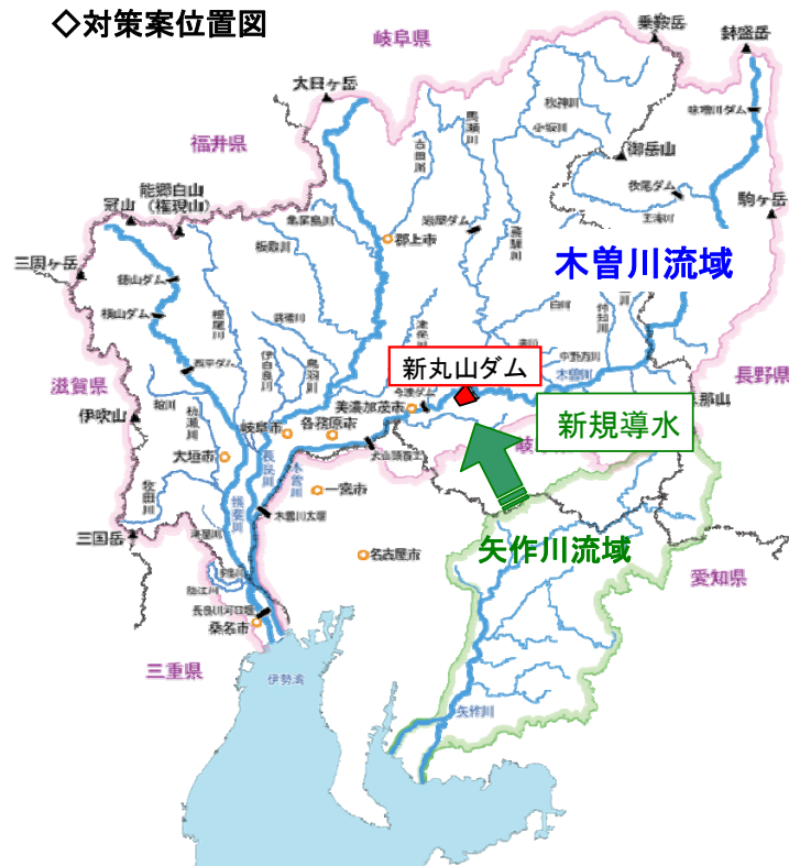
図 4.4.6 水系間導水の概要
