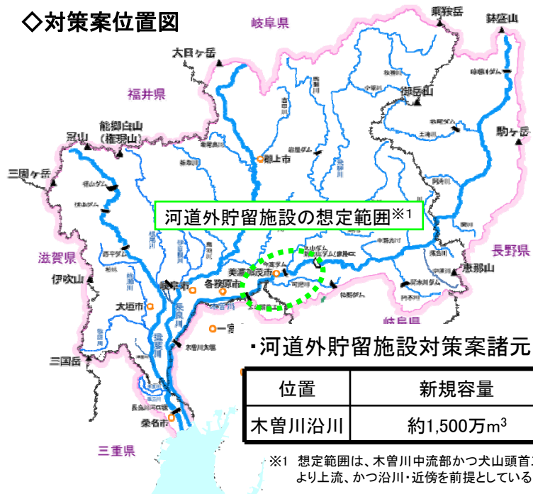
図 4.4.3 河道外貯留施設の概要
