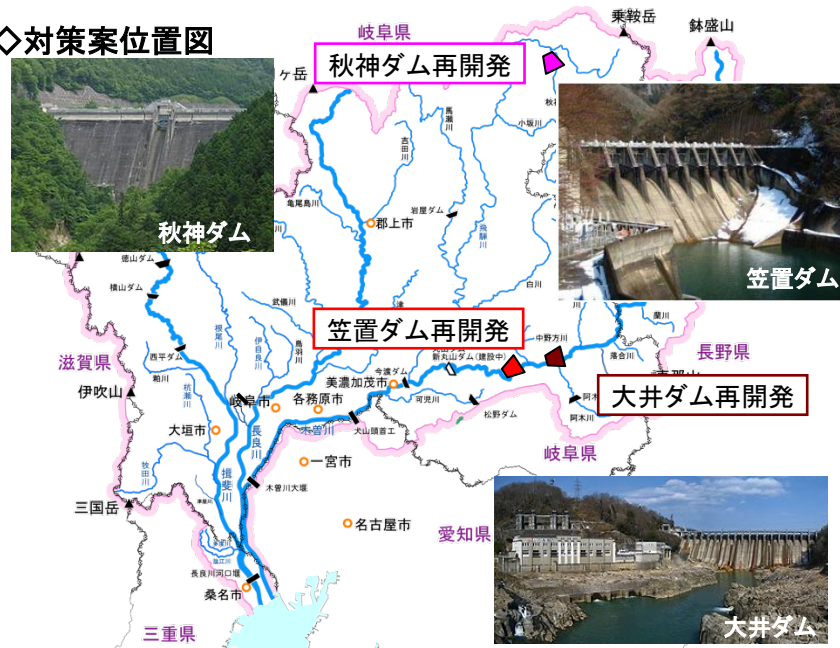
図 4.4.4 ダム再開発（かさ上げ・掘削）の概要
