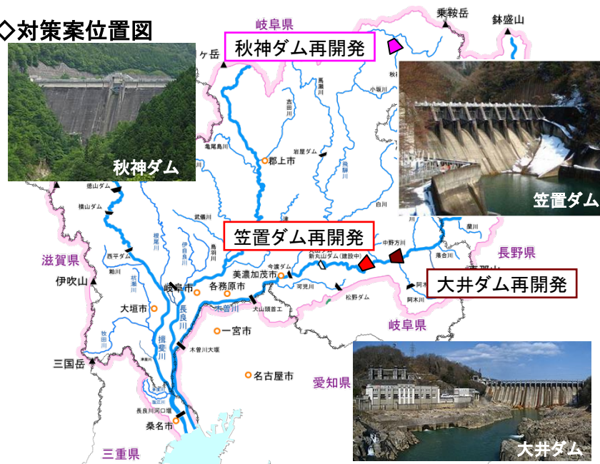
図 4.4.4 ダム再開発（かさ上げ・掘削）の概要
