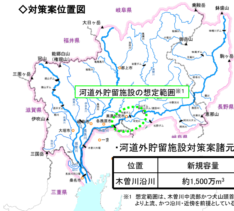
図 4.4.3 河道外貯留施設の概要
