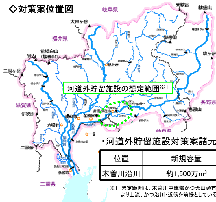
図 4.4.3 河道外貯留施設の概要
