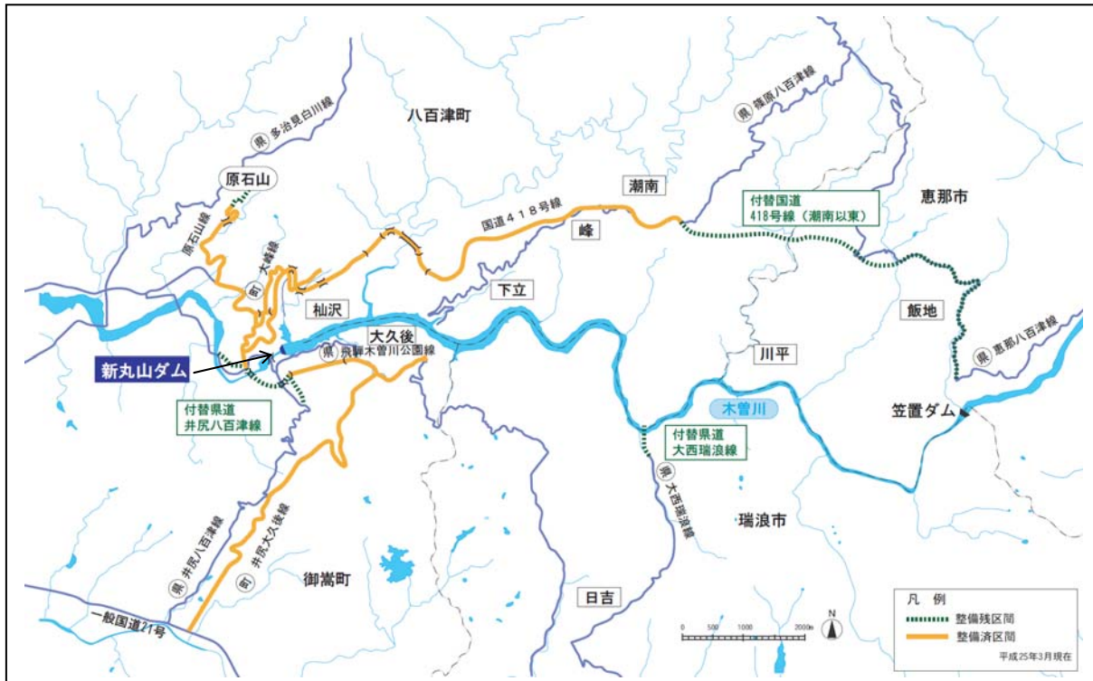
図 4.1.8 新丸山ダム付替道路整備状況
