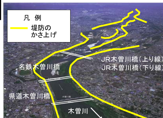
凡例 — 堤防のかさ上げ 橋梁架替 (名鉄木曾川橋・県道木曾川橋 JR木曾川橋(上り線、下り線))
