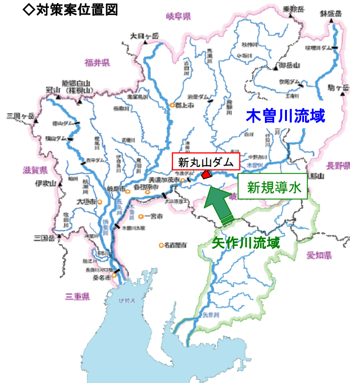
図 4.4.6 水系間導水の概要
