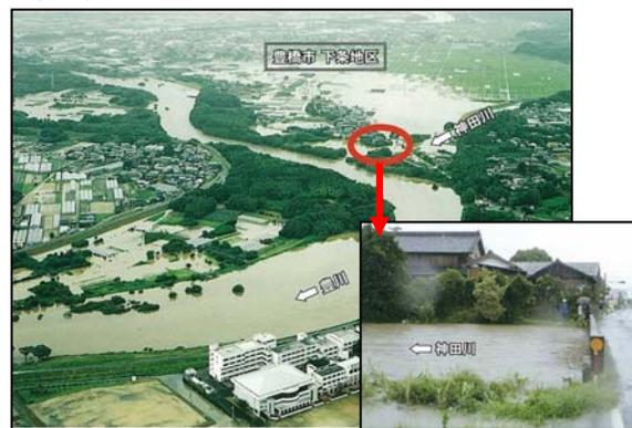
豊川の左岸側には、牛川、下条、賀茂、金沢の4箇所に霞堤と呼ばれる不連続な堤防があり、洪水の一部を貯留する機能を有しているが、その都度、霞堤地区は、浸水被害に見舞われている。
