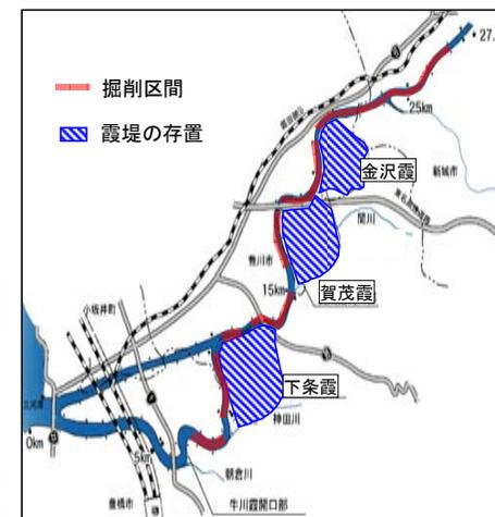
(河道掘削約170万m<sup>3</sup>、樹木伐採約40万m<sup>2</sup>)
