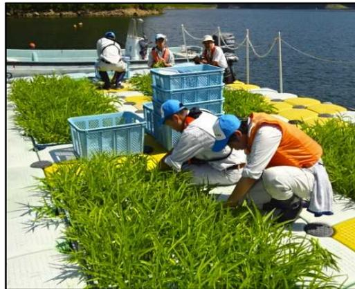
空心菜水耕栽培による水質浄化試験
