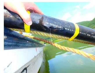
給気管外面ゴム亀裂状況
