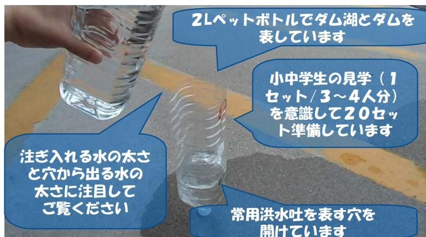
ペットボトルを利用した簡易洪水調節実験
