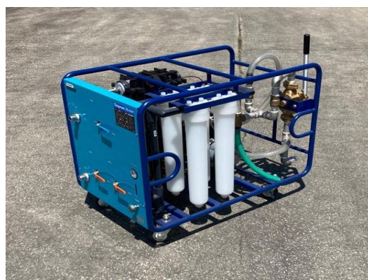
写真-12 緊急用浄水装置（飛騨市）
