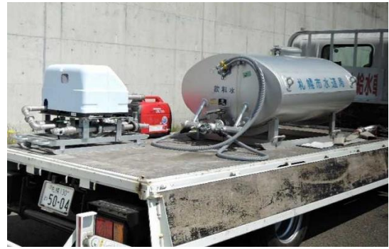
写真-19 簡易給水車の活用
