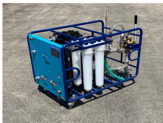
写真-9 緊急用浄水装置（飛騨市）
