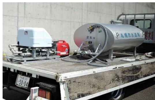
写真- 1 6 簡易給水車の活用
