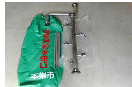
応急給水資材 (消火栓接続用)
