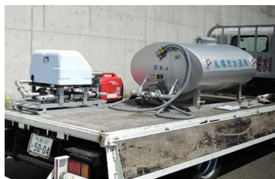
写真- 1 6 簡易給水車の活用
