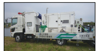
図-14 派遣した排水ポンプ車
