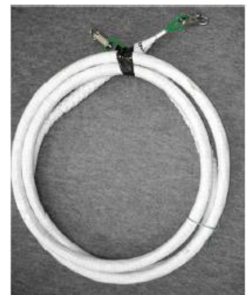
図 ケーブルテストピース（例）
