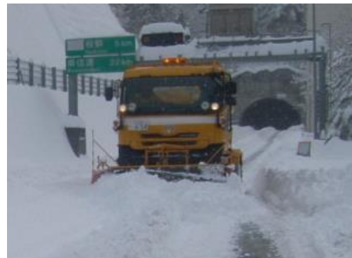
除雪トラックによる除雪作業
