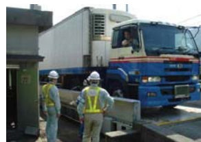
現地取締り状況 (車両重量の測定)
