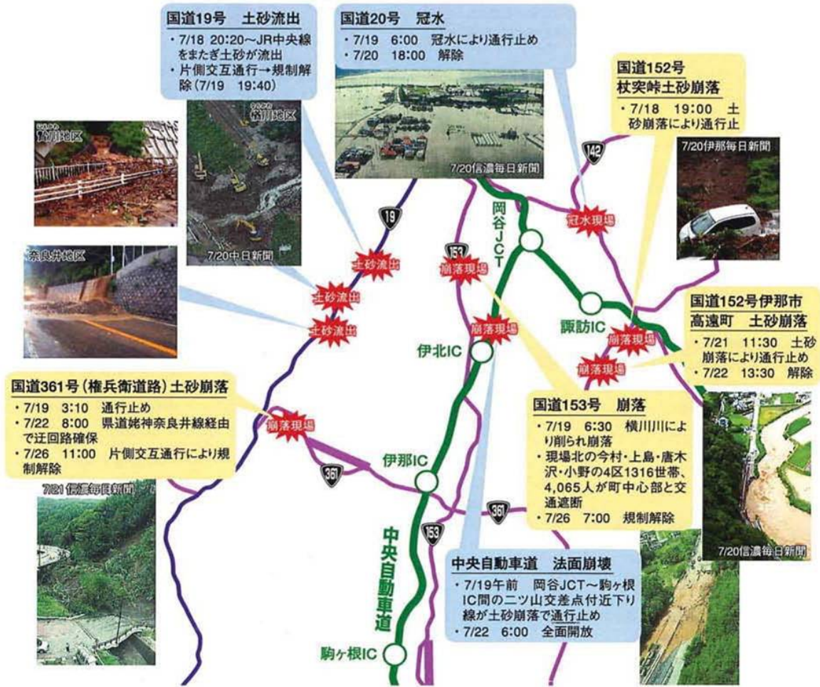
南信地域における道路の被害状況(主要地点)
