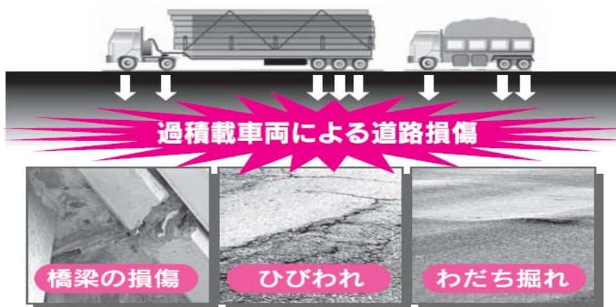
大型車両1台が、軸重10トンの基準よりも2トン超過した場合、橋梁に対しては約9台分の加重が蓄積され、道路が損傷する原因になります。
