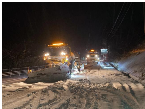
除雪トラックによる除雪作業
