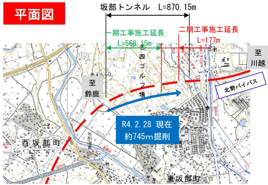
2/28現在、インバート本体工の進捗は613m (トンネル全体の約70%) アーチ覆工の進捗は468m (トンネル全体の約54%) です。
