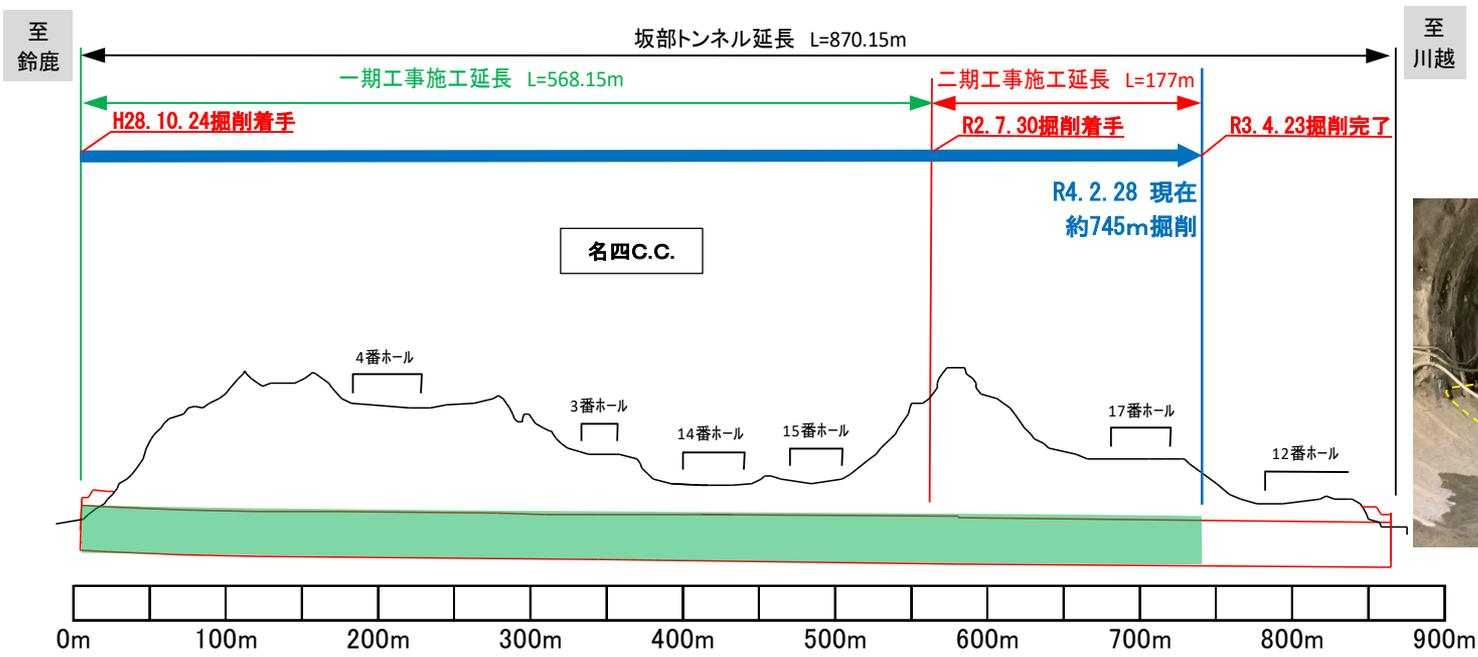
ゴルフ場の直下、かつ崩れやすい地質のため地盤を補強して、トンネル断面を上部から1断面ずつ3分割して掘削しています。
