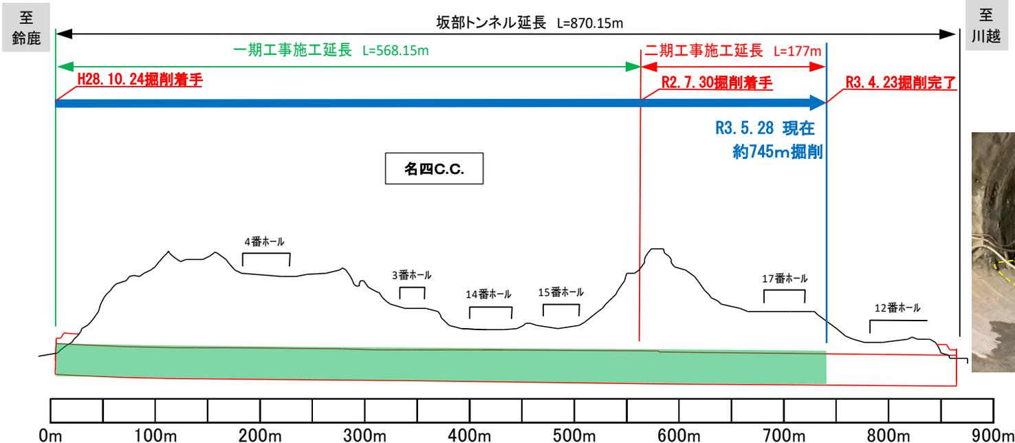
ゴルフ場の直下、かつ崩れやすい地質のため地盤を補強して、トンネル断面を上部から1断面ずつ3分割して掘削しています。
