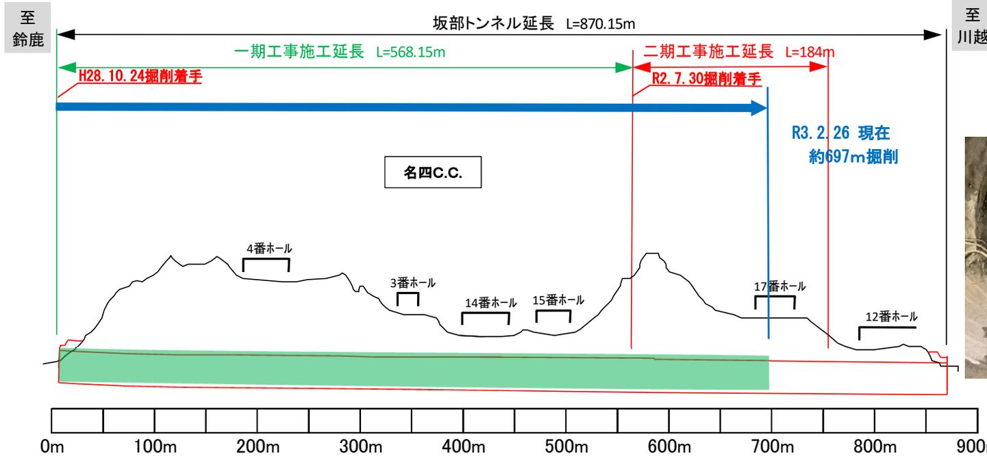
ゴルフ場の直下、かつ崩れやすい地質のため地盤を補強して、トンネル断面を上部から1断面ずつ3分割して掘削しています。
