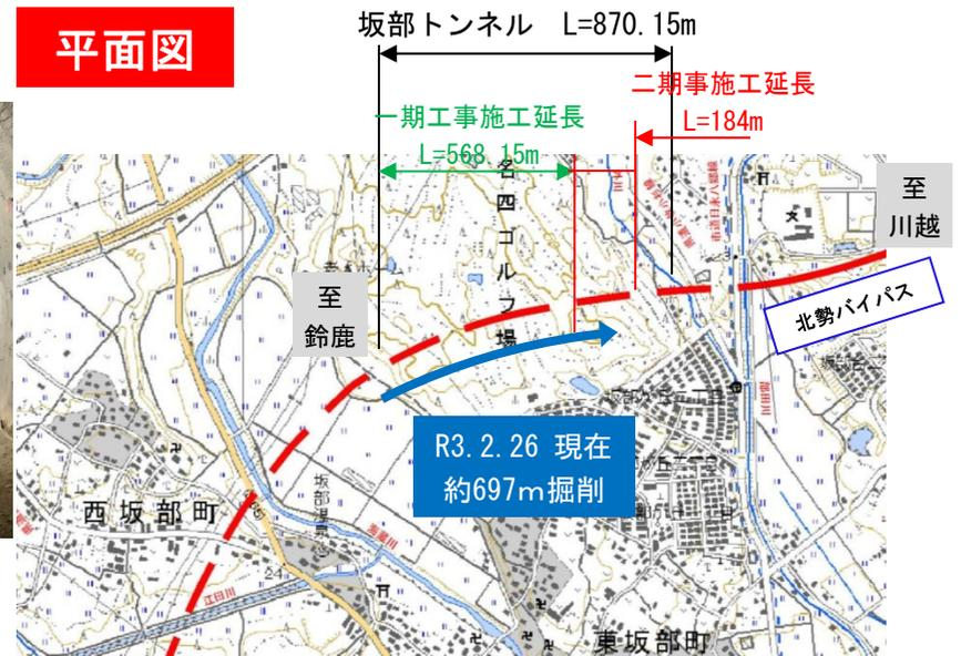
トンネル上部は697m、中間部は692m、下部は689mの掘削が完了しています。切羽の地質は大きく区分して上部より砂層、砂レキ層、粘土層の3種類の地質となっています。引き続き、トンネル天端部および切羽(正面)に鋼管を打設し薬液を注入する補強工事を行ないながらトンネル掘削を行っています。
