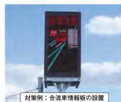
対策例:合流車情報板の設置
