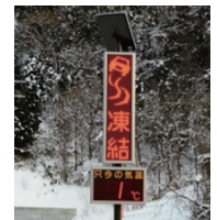
対策例: LED電光表示板の設置
