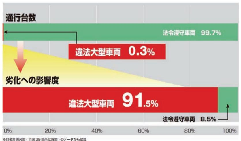
違法に重量制限を超過する大型車両の走行は、**大事故**を引き起こす恐れがあるばかりか、**道路の橋や舗装などの劣化**を早めます！
