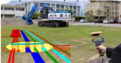
現地で簡単に図面などのデータ確認ができる体験として、埋設物が風景と重ね合わせて表示される端末の体験ができます。
