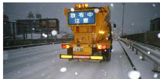
凍結防止剤散布車による通行確保
