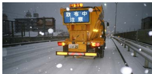
凍結防止剤散布車による通行確保
